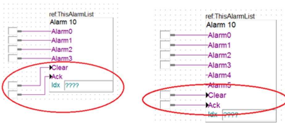
La connexion par bus peut aussi être utilisée pour connecter plusieurs points de construction à des entrées ou sorties de FBox successives, comme montré dans l'exemple ci-dessous.
