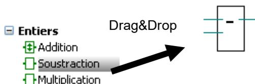
Le funzioni necessarie per scrivere un programma devono essere selezionate dalla finestra *Fbox Selector (Selettore FBox)*, ed inserite nel programma Fupla utilizzando la funzione *Drag&Drop (Trascina e Rilascia)*.
