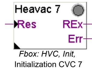
Dopo una qualsiasi operazione di trasferimento del programma e ripartenza a freddo del PCD, l'ingresso *Res* di questo FBox, ed i parametri di configurazione illustrati nella figura seguente, esercitano una importante influenza sull'inizializzazione dei parametri di configurazione per tutti gli altri FBox HEAVAC utilizzati nel programma.
