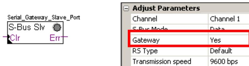
E' necessario impostare a "Yes" il parametro di configurazione "Gateway". In base al tipo di canale, devono poi essere correttamente definiti i vari parametri presenti nella finestra di personalizzazione dell'Fbox.
