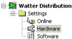
Permette di configurare la memoria, i parametri di comunicazione e la password del PCD. Queste informazioni vengono salvate in un file di progetto PG5. L'utente deve utilizzare il pulsante *Trasferimento a PCD* per forzare il trasferimento dei dati di configurazione nella memoria del PCD.
