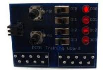
L'entrée DI0 du print de simulation peux maintenant être utilise pour enclencher et déclencher la sorite DO0
