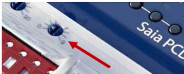
Zur einfachen Installation sollten Sie den Kommunikation Parameter 'Auto-detect Baud Rate' auf 'Yes' einstellen. Danach können Sie die Konfiguration über die USB Verbindung herunterladen und das Gerät zum S-Bus Netzwerk hinzufügen. Mit der verwendeten RS-485 Schnittstelle kann die Inbetriebnahme nun mit dem Gateway der Master-PCD aus der Ferne durchgeführt werden.
