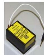
Falls in der PCA-SPS ein EPROM steckt, bei der eine Ergänzung oder Änderung im Programm gemacht werden soll, wird noch RAM-Speicher benötigt um das Programm testen zu können. Die Grösse des RAM-Speichers sollte mindestens dem des EPROM entsprechen.
