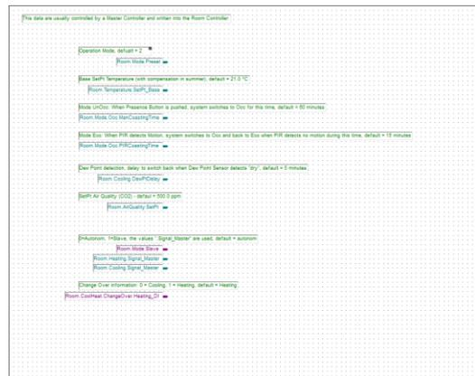
In vielen Fällen wechselt eine Master-SPS die Betriebsart am Morgen von Nicht belegt (UnOccupied) zu Öko (Bereitschaft) (Eco (Standby)) und am Ende des Tages zurück zu Nicht belegt (UnOccupied). Auch die Basistemperatur, z. B. im Sommer verschoben und die Informationen für 2-Rohr-Anwendung, um die Raumanwendung zu informieren, wenn eine Heizung oder Kühlung aktiv ist.
