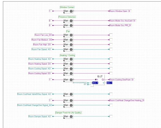
Die Ausgänge können auch in einer Mischung, z. B. 1xAO für eine Heizung mit kontinuierliche Ansteuerung und 1xDO für die Kühlung mit PWM-Ansteuerung.
