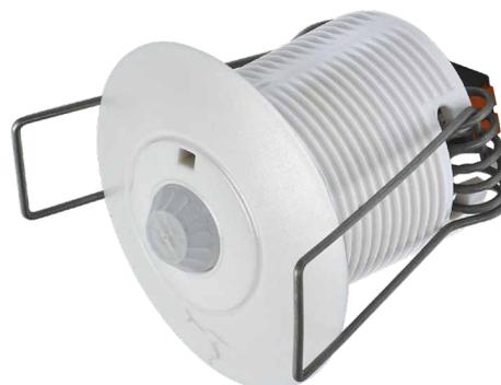
Il multisensore SBC permette di adattare il comfort ambientale in funzione dell'occupazione del locale (rilevamento di movimento), di regolare l'intensità luminosa grazie al sensore di luminosità e di modificare i parametri di comfort mediante il telecomando multifunzione o HVAC. È provvisto di un trasmettitore-ricevitore Bluetooth.
