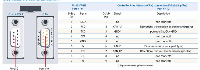
Les CPU PCD3.M6340 sont équipées d'une interface CAN haute vitesse de 1 Mbit/s, séparée galvaniquement.
