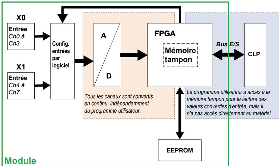
La configuration du module s'effectue dans le configurateur matériel du PG5. Le programme utilisateur peut lire les valeurs des entrées ou les configurations des entrées par les registres spécifiques.
