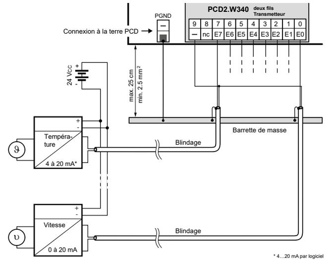
Les transducteurs deux fils requièrent une alimentation 24 VCC dans la ligne de mesure.
