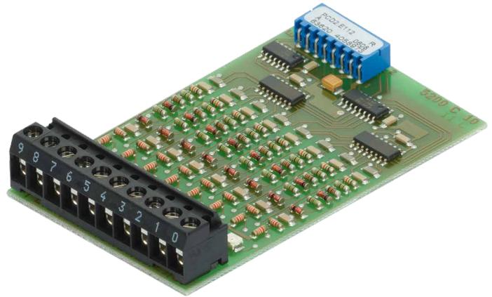
Preisgünstiges Eingangsmodul für Quell- oder Senkbetrieb mit 8 Eingängen, galvanisch verbunden. Geeignet für die meisten elektronischen und elektro-mechanischen Schaltelemente an 12 VDC.
