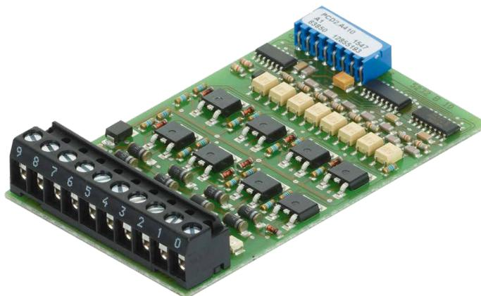
Module de sortie avec séparation galvanique avec l'UC, 8 sorties à transistors MOSFET sans protection contre les courts circuits. Plage de tension 5 à 32 VCC.
