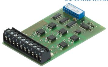
Preisgünstiges Ausgangsmodul mit 6 Transistorausgängen im Strombereich von je 5 mA ... 2 A, ohne Kurzschluss-Schutz. Die einzelnen Stromkreise sind galvanisch verbunden, der Spannungsbereich geht von 10 ... 32 VDC.
