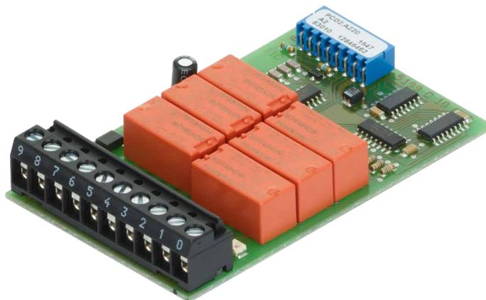
Le module comprend 6 relais avec contacts travail pour tension continue et alternative jusqu'à 2 A, 250 VCA. Le module convient tout particulièrement lorsque des circuits de courant alternatif avec une fréquence de commutation faible doivent être contrôlés. Pour des raisons de place, il n'y a pas de protection des contacts intégrée. Un groupe de 3 relais se partage un même raccordement.
