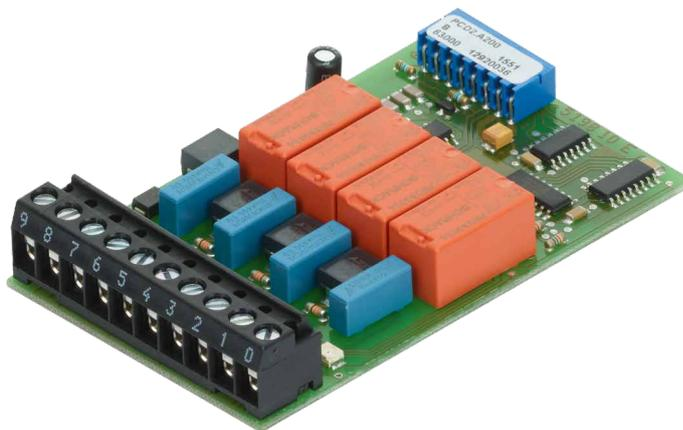
Le module comprend 4 relais avec contacts travail pour tension continue et alternative jusqu'à 2 A, 250 VCA. Les contacts sont protégés par une varistance et un module RC. Le module convient tout particulièrement lorsque des circuits de courant alternatif entièrement séparés avec une fréquence de commutation faible doivent être contrôlés.
