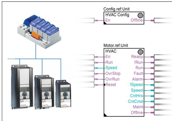
▲ FBox à disposition pour les variateurs de fréquence
