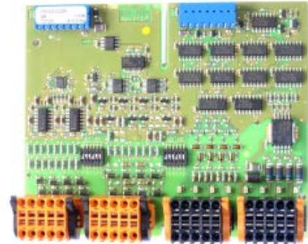
Das PCD2.G200 ist ein Doppel E/A-Multifunktionsmodul, welches sowohl in der PCD1.M2xxx als auch in der PCD2.M5xxx eingesetzt werden kann. Das Modul belegt zwei E/A-Steckplätze. Das Modul ist vor allem für die PCD1.M2xxx sehr interessant, welche nebst den onboard E/A's über zwei freie Steckplätze für zusätzliche E/A-Module verfügt. Mit dem Einsatz des PCD2.G200 wird mit der PCD1.M2xxx ein Total von 41 Ein- und Ausgängen erreicht.
