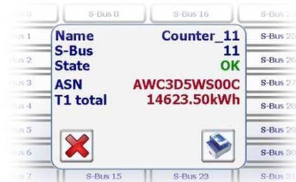
Le compteur d'impulsions via le module H104 s'affiche sous la forme d'un compteur unique. La navigation entre les différentes données se présente sous la forme d'un menu contextuel.
