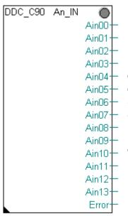
Il existe un maximum 14 entrées qui peuvent disposer indépendamment de 7 différentes **sélections de mode**. Le **mode rapide** n'est pas doté d'un filtre 50/60 Hz.
