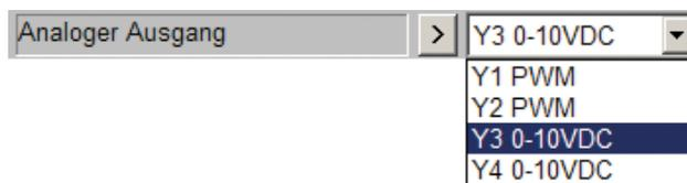
Alle Ausgänge sind grundsätzlich analoge Ausgänge. Die Ausgänge Y3 und Y4 arbeiten proportional mit 0-10 V. Die schaltenden Elemente wie Triac (Y1 und Y2) werden pulsweitenmoduliert (PWM) betrieben. Die Zykluszeit wird in den Hardware Einstellungen angegeben. Alle Werte zwischen von 0.1 bis 99.9 bestimmen das Puls/Pausenverhältnis. Ein PWM Ausgang wird mit dem Wert 0 dauerhaft ausgeschaltet und mit Wert 100.0% bleibt er eingeschaltet.
