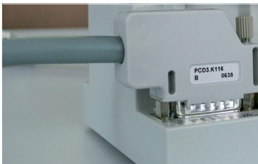
Cavo PCD3.K106/116 HW versione B, con innesto a 90°
