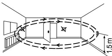
Ne pas installer le dispositif à proximité de fenêtres ou de portes pour éviter les courants d'air.
