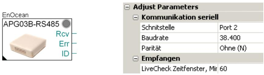
La baud rate delle FBox deve coincidere con quella impostata sul dispositivo gateway Omnio !
