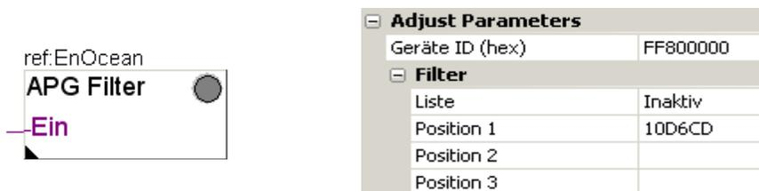
Nel campo "Device Identifier ID" si inserisce l'ID del gateway. Dopo aver fatto questo, gli ID dei sensori ricevuti da tale gateway possono essere registrati nella tabella. Tramite l'ingresso "In" ("Ein") della FBox a disposizione, la lista viene trasmessa al gateway.
