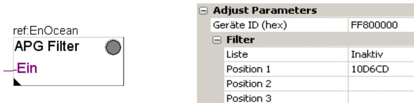
Im Feld „Device Identifier ID“ wird die ID des Gateways eingegeben. Anschliessend können die IDs der Sensoren, welche von diesem Gateway empfangen werden in die Tabelle eingetragen werden. Bei gesetztem FBox-Eingang „En“ wird die FBox die Liste an den Gateway übertragen.
