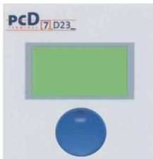
Die Bedienung mit nur einem Drehknopf erfolgt durch Drehen und Drücken zur Auswahl von Untermenü-Strukturen und von verschiedenen Prozess-Parametern.
