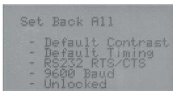
**PCD7.D230:** Durch Drücken des Drehknopfs werden die Werkseinstellungen wiederhergestellt.
