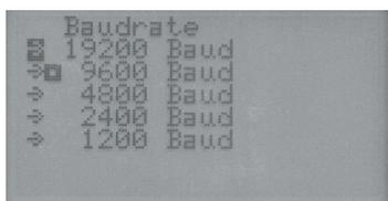
Hier wird die Baudrate entsprechend dem Kommunikationsmodus und den angeschlossenen Geräten (Saia PCD® oder PCS) eingestellt (siehe auch Kapitel 4). (Die Baudrate lässt sich auch im HMI-Editor einstellen.)
