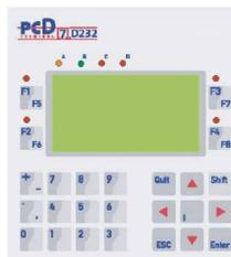
Mit 8 Funktionstasten, 1 numerischen Tastatur und 8 LEDs können Werte eingegeben und Prozesse gesteuert und überwacht werden.
