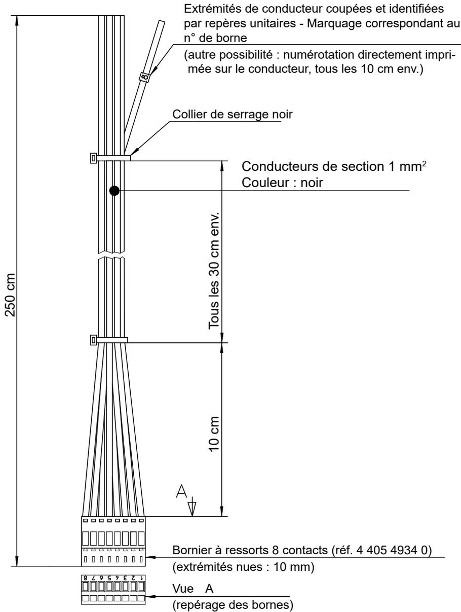
8 conducteurs de section 1 mm<sup>2</sup>, maintenus par colliers, longueur : 2,5 m Côté PCD : bornier à ressorts embrochable 8 contacts, type J Côté procédé : conducteurs numérotés, non gainés
