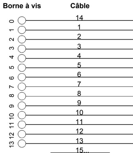
Câble rond et gainé, constitué de 14 conducteurs de section 0,5 mm<sup>2</sup>.
