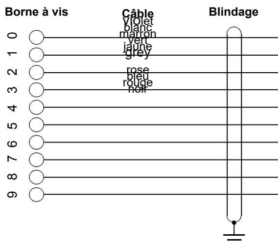
Câble gainé et blindé, constitué de 10 fils de section 0,25 mm<sup>2</sup> (blindage aux deux extrémités) :
