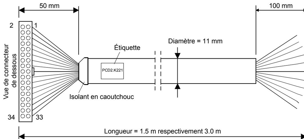
Câble rond et gainé, constitué de 32 conducteurs de section 0,25 mm<sup>2</sup> (AWG 24)
