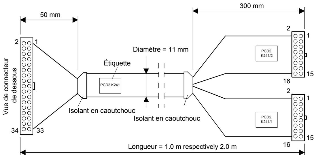
Câble rond et gainé, constitué de 34 conducteurs de section 0,09 mm<sup>2</sup>.
