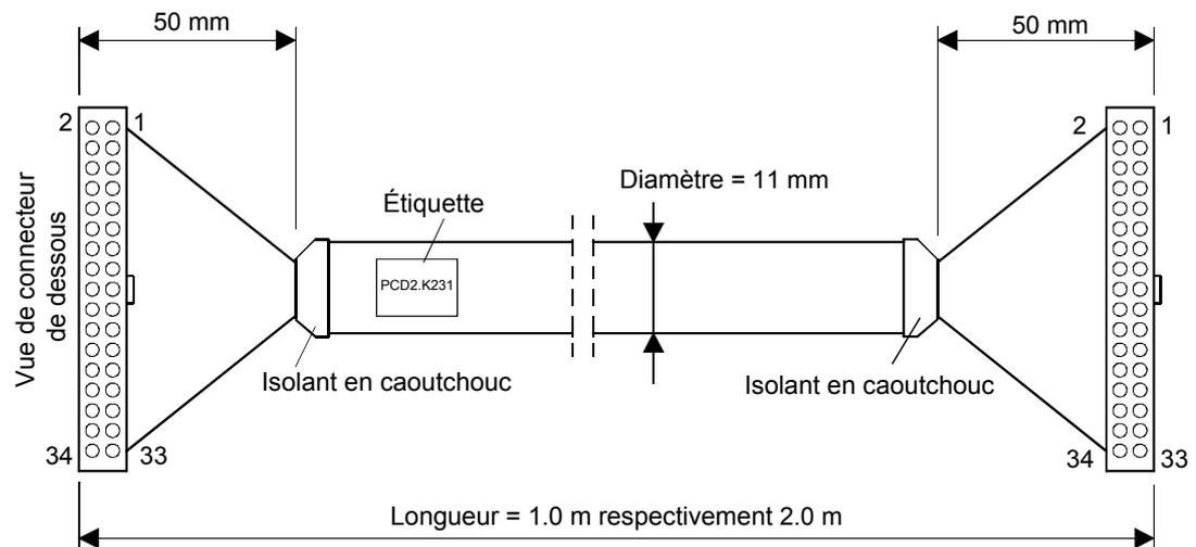
Câble rond et gainé, constitué de 34 conducteurs de section 0,09 mm<sup>2</sup>.
