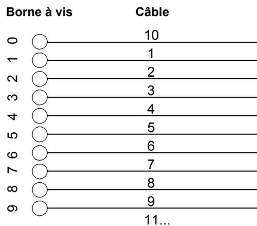
Câble rond et gainé, constitué de 10 conducteurs de section 0,5 mm<sup>2</sup>.
