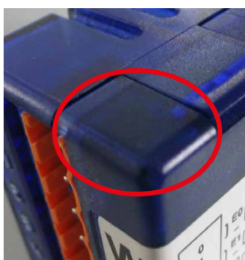
Vecchi moduli senza possibilità di fissaggio
