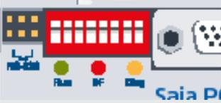
Les trois voyants situés sur la station de tête PCD3.T76x signalent les états de fonctionnement du RIO (erreur, alarme, diagnostic, etc.). Leur utilisation est décrite dans le tableau ci-dessous.
