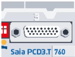
Ce raccordement permet d'enrichir le RIO d'un maximum de 3 supports de modules LIO (à l'aide du connecteur PCD3.K010). Chaque RIO bénéficie ainsi de 256 E/S.
