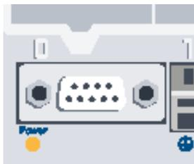
Le bus est prévu pour un débit en bauds de 1,5 Mbps maximum. Vous trouverez des détails sur les spécifications de la communication avec Profibus dans le manuel 26-765 « Profibus DP ».
