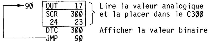
Avec module PCA1.W3.. (12 bits)
