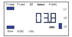
Exemple: Erreur de connexion sur L1 et L3
