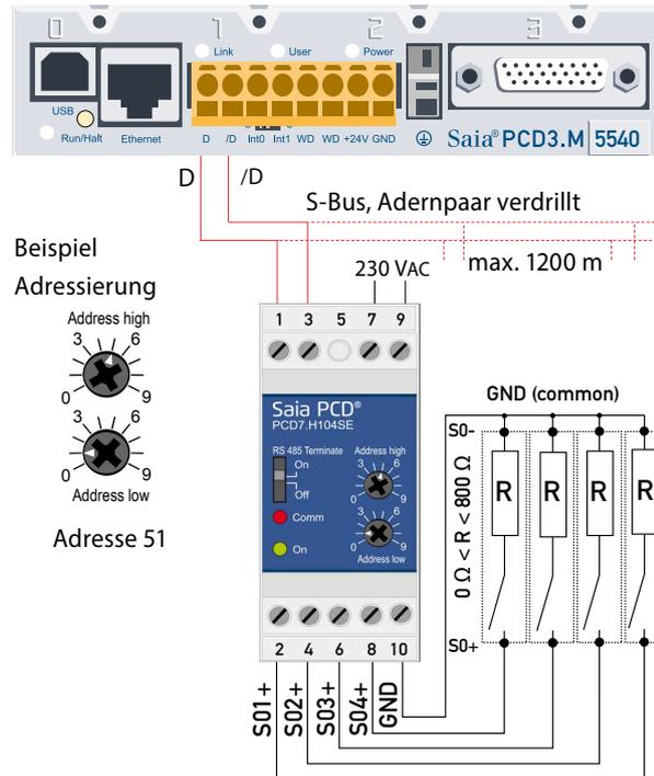
Hinweis: Wird das S-Bus Modul als letztes Gerät eingesetzt, muss der Schiebeshalter «RS-485 Terminate» in Stellung «On» sein.
