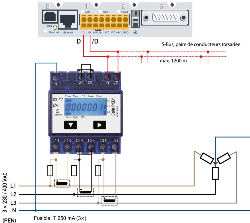
**!** Le branchement secondaire côté secteur du transformateur d'intensité doit être relié à la phase à mesurer et le transformateur d'intensité ne doit pas être mis à la terre dans ce cas.
