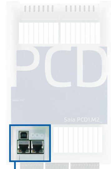
Caratteristiche di base dei Saia PCD®: USB e Ethernet integrate come standard. La porta USB consente una più semplice manutenzione senza la complessità IP e il rischio di interruzioni di rete. In aggiunta, sono sempre disponibili 2 interfacce seriali, espandibili sino ad un massimo di 12 connessioni seriali.
