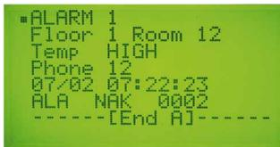
Die Registerkarte «alarm» wird benutzt, um eine Liste von mit Merkern (Flags) verbundenen Alarmen zu erstellen und um Alarmmeldungen im Puffer zu definieren. Für jeden Alarm können 4 Linien Text definiert werden, + 2 Linien für das Datum, die Zeit, den Alarmzustand, Quittierung und die Alarmnummer.
