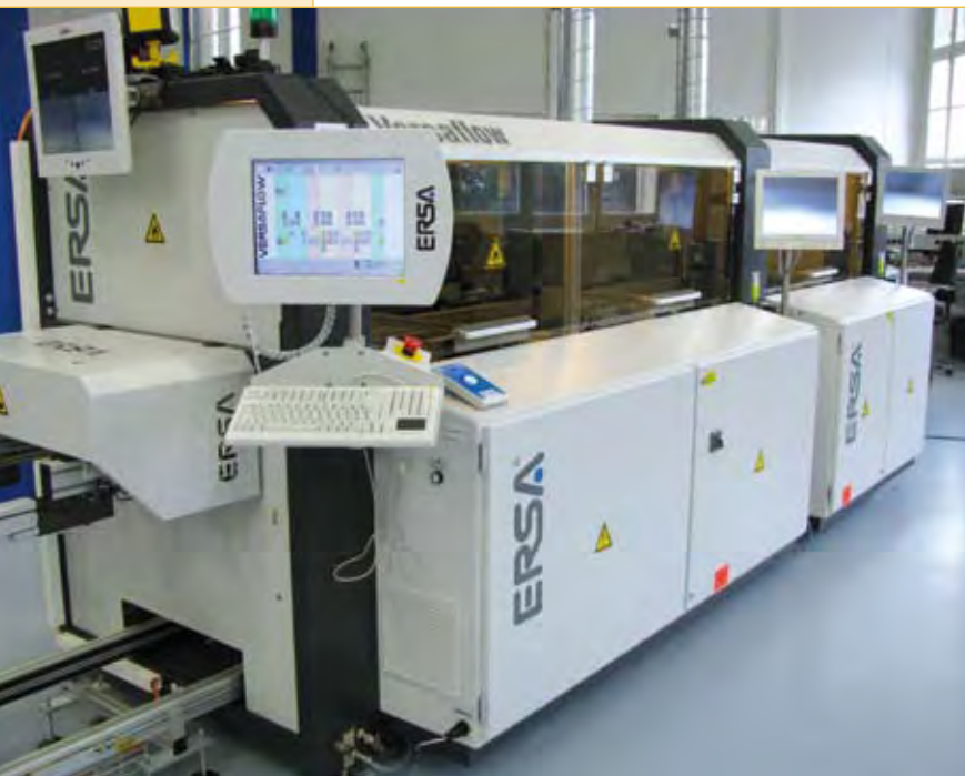
Nieuwe selectieve soldeermachine in de productie van Saia®PCD
