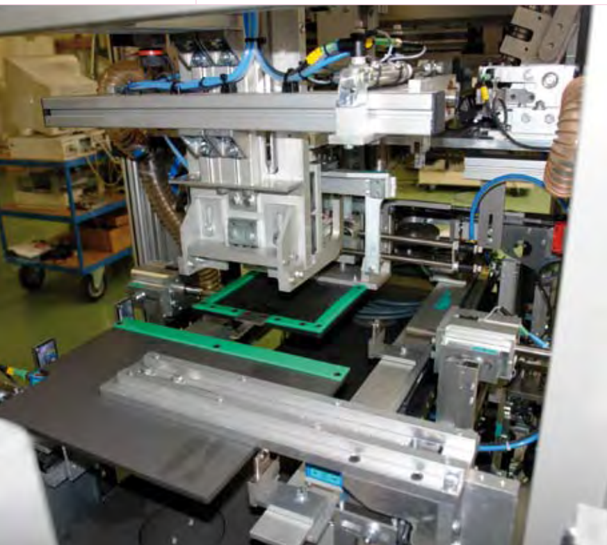
De beugels worden door middel van pneumatiek aan de emmer gemonteerd. De contrastsensor aan de linkerkant detecteert de aanwezigheid van een zwart-wit label op de emmer.
