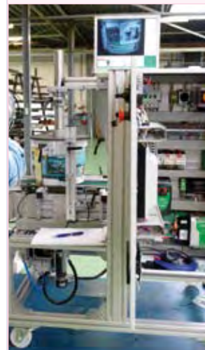
Een beugelmachine in opbouw in de productiehal van Polymac in Ede. Rechts is de besturingskast te zien met Saia®PCD2 controller.
