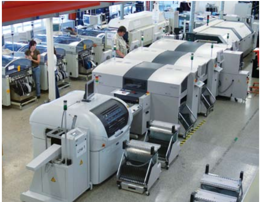
Productie van Saia-Burgess Controls: SMD-productielijnen met drie nieuwe machines
