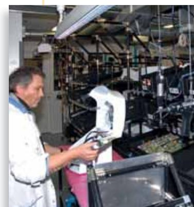
▲ Linea di montaggio del sistema di gestione energetica per il sistema di microgenerazione Vaillant/Honda: sulla linea di produzione creata appositamente per questo prodotto, le schede Saia® Vengono montate e testate secondo metodi Lean.
