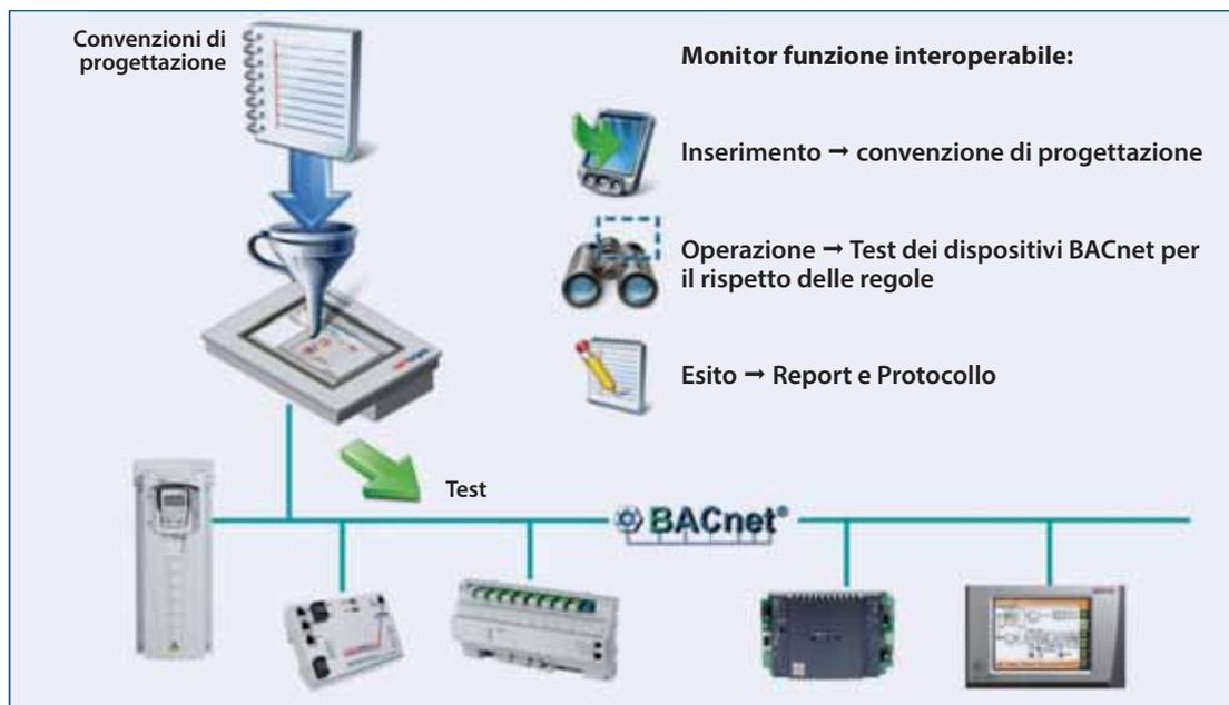
BACnet-Monitor consente un monitoraggio "live" completamente automatico dell'intera installazione. Per garantire lo stesso rispetto durante il funzionamento, come al momento del collaudo, BACnet-Monitor verifica la conformità alle regole concordate inizialmente di ogni dispositivo BACnet presente. Eventuali deviazioni sono registrate e comunicate al gestore.
