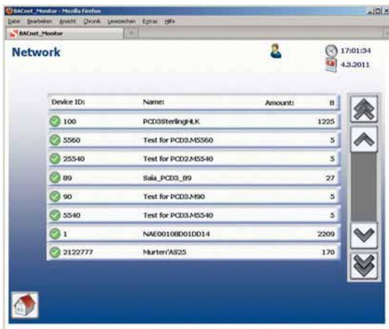
▲ I dispositivi BACnet sono presentati in una forma facilmente comprensibile. Nella foto: un sistema di prova con controllori JCI, Saia, Sauter e Siemens.
