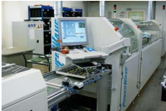
Nuova macchina di saldatura ad onde per il processo senza piombo
