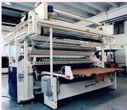
Gemata Spa: macchine per la rifinizione delle pelli.
