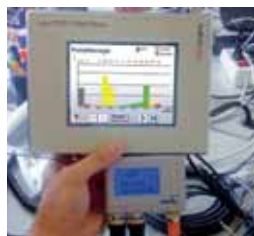
▲ HMI fonctionnel Saia en tant que KSB Pumpmanager avec KSB Pumpmeter dans le centre de développement de KSB
