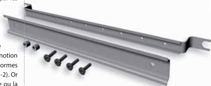
▲ Rail DIN, colonne vertébrale de « l'automate fabriqué maison » par le constructeur d'armoires de commande. Il doit être fourni par le fabricant de composants électroniques, ce qui n'est presque jamais le cas dans la pratique. Le rail DIN ne doit pas être tordu, ce que personne ne remarque à la réception. Tout desserrage du montage risque d'entraîner de fâcheuses conséquences et des erreurs dont les causes sont difficilement identifiables.
