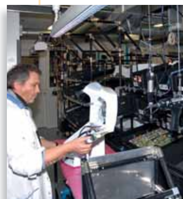
▲ Chaîne de montage du gestionnaire du système et d'énergie pour le système de micro-cogénération Vaillant/Honda : les modules Saia® sont montés et testés selon les méthodes Lean sur la chaîne de production spécialement conçue pour ce produit.
