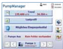
▲ Le KSB Pumpmanager basé sur le PCD fonctionnel Saia® est également librement program- mable avec Step7 de Siemens.
