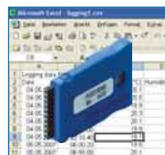
Enregistrement des données sur carte flash au format .csv
