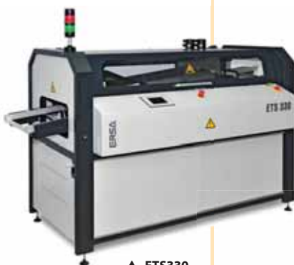
▲ ETS330 Machine de soudage double vague compacte avec l'unité centrale Saia® PCD2 et le pupitre MB Saia 5,7"
