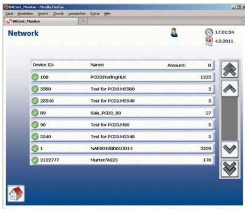
▲ Les appareils BACnet sont représentés de façon globale sous une forme facilement compréhensible. Dans l'image : une installation d'essai comprenant des contrôleurs de JCI, Saia, Sauter et Siemens.
