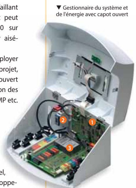
1 Carte mère Saia®PCD standard 2 Compteur d'énergie monophasé Saia® 3 Carte E/S spécifique Vaillant
