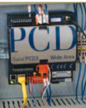
Saia®PCD3.WAC intégré et son câble d'antenne GSM
