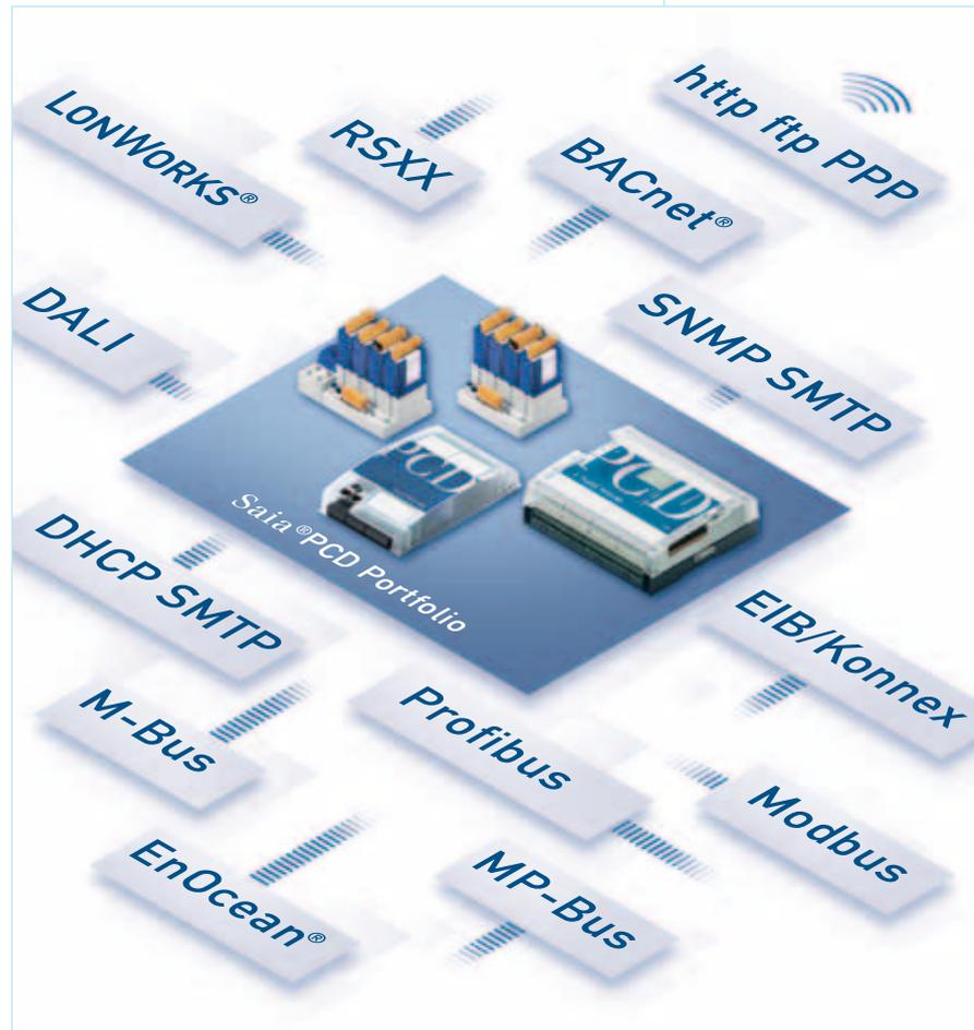
ties de coupleurs spécifiques comme Profibus, CAN, modems (RTC, RNIS, GSM/GPRS) et bien d'autres. De plus, la totalité de nos systèmes peut toujours s'enrichir de modules complémentaires puisés dans une large palette d'exécutions. Pour preuve, l'évolutivité modulaire d'un Saia®PCD se traduit par un maximum de 16 ports de transmission (unité centrale PCD2.M5) regroupées dans un seul boîtier compact.
