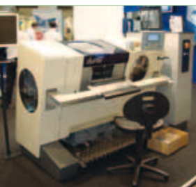
La première machine dotée des nouveaux modules H lors d'un salon. Une commande Saia®PCD3 pilote la machine DURRER.
