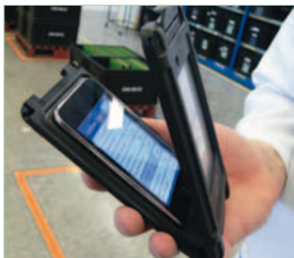
Boîtier industriel en tant qu'« emballage » pour l'iPod
