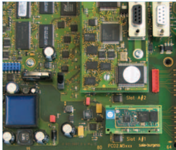
Le module Bluetooth Saia®PCD7.F160S monté sur l'emplacement A d'un Saia®PCD2.M5540
