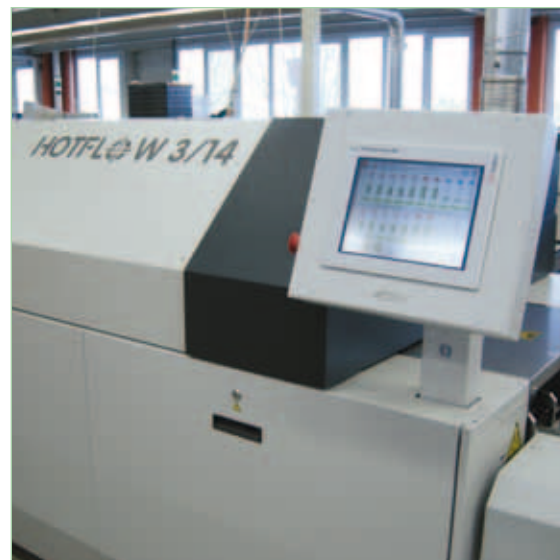
Machine ERSa avec écran Web Saia®PCD Micro-Browser de 10"
