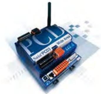
Terminal Unit) classique, le WAC embarque d'office 10 entrées TOR, 4 entrées analogiques configurables et 2 sorties à relais. Et si cette configuration ne suffit pas, il peut s'enrichir d'un boîtier d'ex-
