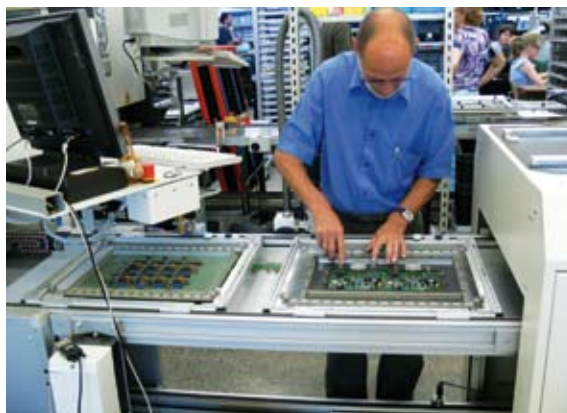
Production de Saia-Burgess Controls avec trois nouvelles lignes de montage CMS
