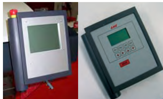
Version « confort » du pupitre portable, bâtie sur le « Saia®Web-Panel MB »
