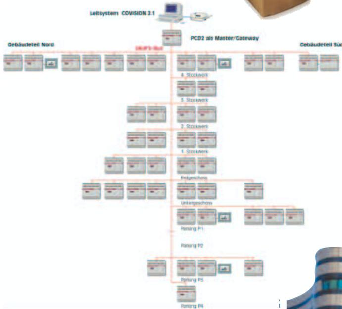
Sur les dix étages du complexe commercial, chacun des 45 SAIA®PCD2 pilote une zone climatique. Reliés par le SAIA®S-BUS, ils sont aussi connectés au système de gestion COVISION 2.1 par le biais de la station maître/passerelle.
