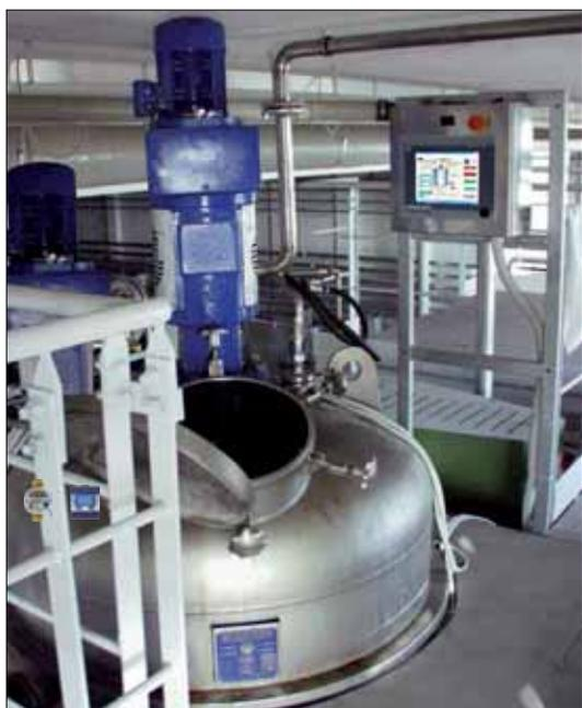
▲ Chemischer Reaktor mit WEB-HMI
