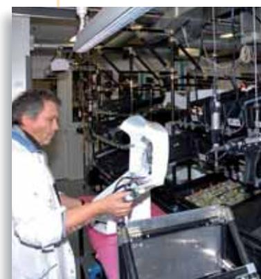
▲ Montagelinie System- und Energiemanager für das Micro KWK-System Vaillant/Honda: Auf der eigens für dieses Produkt erstellten Produktionslinie werden die Saia® Boards nach Lean-Methoden montiert und getestet
