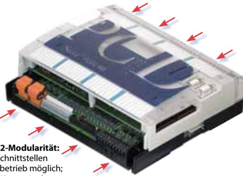
▶ **Beispiel Saia® PCD2-Modularität:** bis zu 12 Schnittstellen im Parallelbetrieb möglich; bis 1024 E/A erweiterbar
