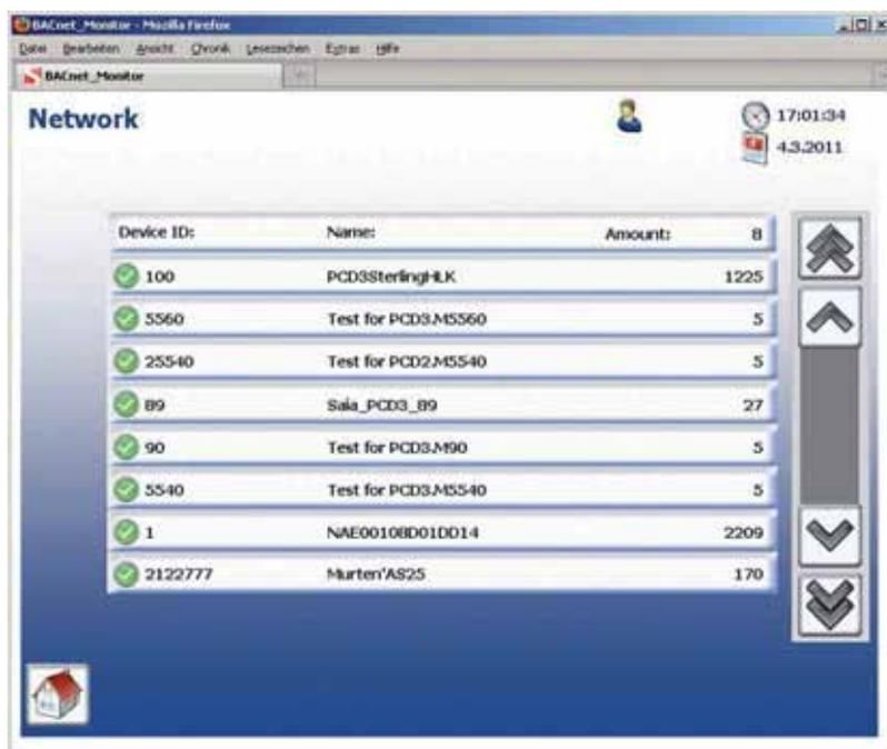
▲ BACnet-Geräte werden in leicht verständlicher Form übersichtlich dargestellt. Im Bild: eine Testanlage mit Controllern von JCI, Saia, Sauter und Siemens.
