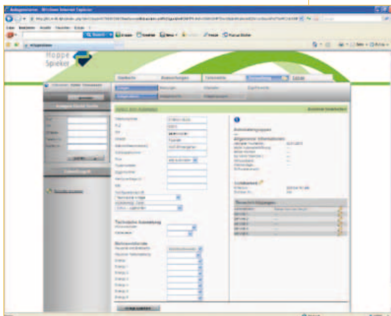
Web-Bedienmaske zur Konfiguration der Anlagen- und Störungsmeldungen
