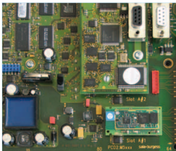
Saia®PCD7.F160S-Modul auf Steckplatz A einer Saia®PCD2.M5
