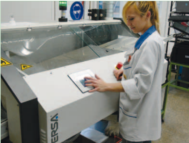
Mit Saia®PCD gesteuerte ERSA-Lötmaschinen in der Produktion bei Saia-Burgess in Murten. Komfortables Bedienen mit Saia®PCD Web-Panels.
