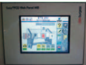
5.7" Saia®PCD Web-Panel MB. Das Web-Panel ermöglicht die Integration der Maschine in das Firmennetzwerk
