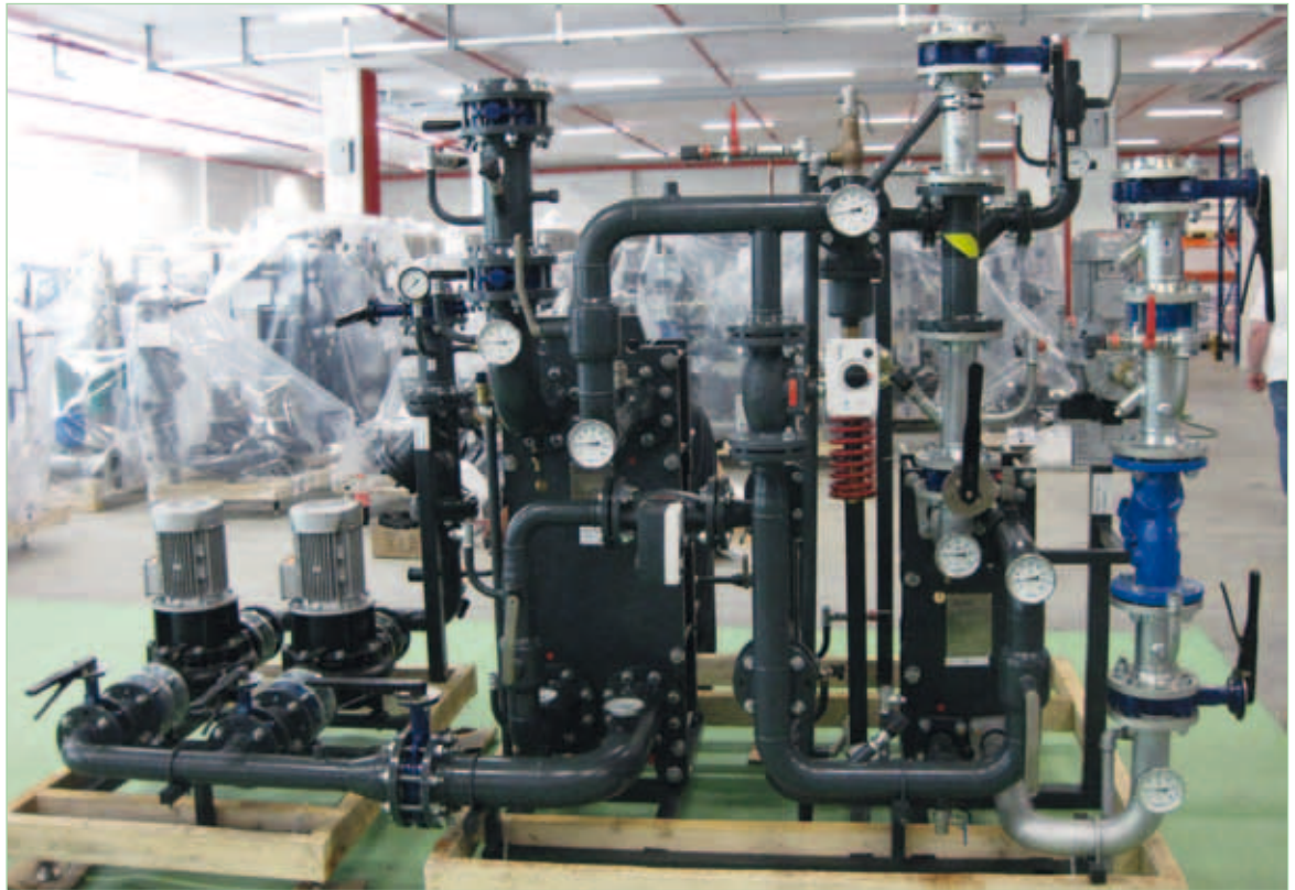
Eine von über 100 Wärme- übergabe-Stationen versandbereit für das Projekt Iasi/Rumänien
