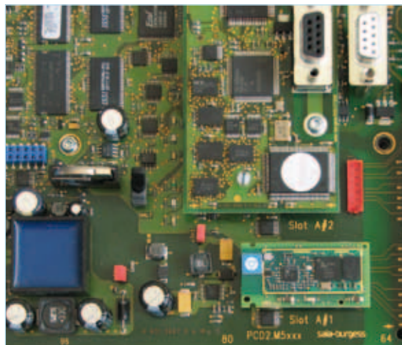
Saia®PCD7.F160S-Modul auf Steckplatz A einer Saia®PCD2.M5
