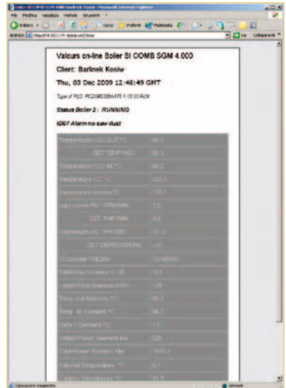
Remote Abfrage des Boilerstatus über Browserinterface. HMI-Applikation liegt im Web-Server der Saia®PCD3.WAC
