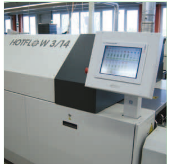
ERSA-Maschine mit Saia®PCD 10" Micro-Browser Web-Panel
