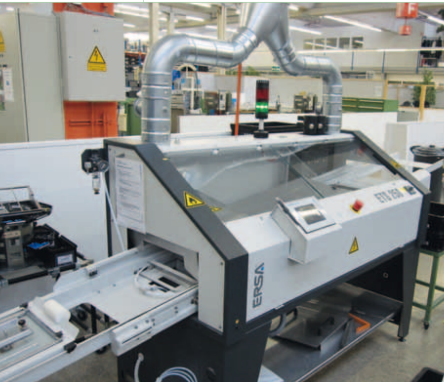
Die neue kleine ERSA-Lötmaschine mit Saia®PCD2.M5 und 5.7" Web-Panel MB bei Saia-Burgess in Murten
