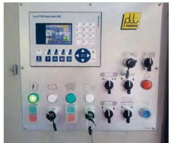
Die Bediener-Schnittstelle der neuen Maschine mit dem 3.5" Saia®PCD Web-Panel im Zentrum
