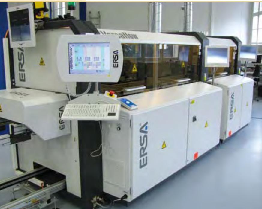
Neue Selektivlötmaschine für die Saia®PCD Produktion
